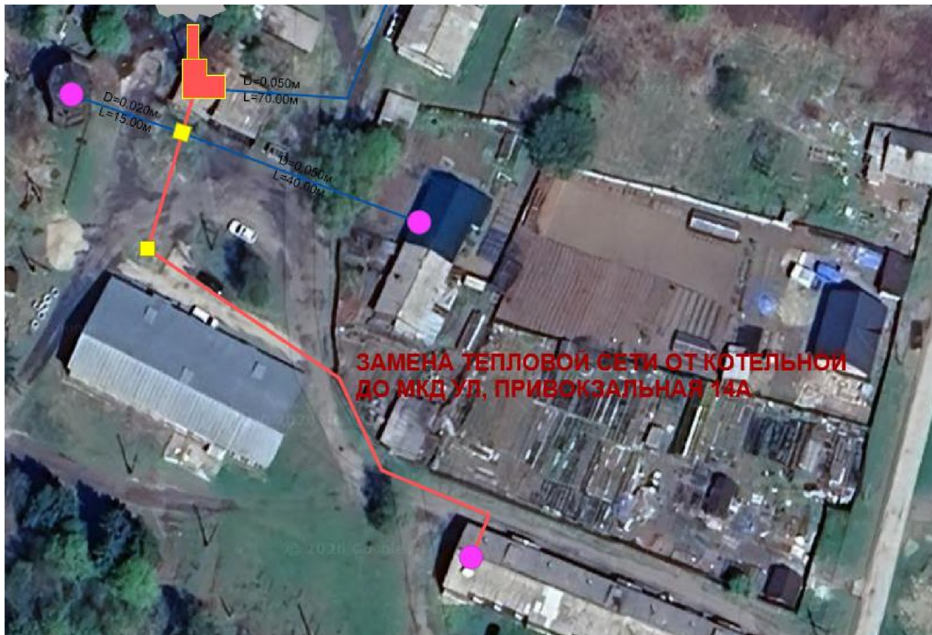
Рисунок 9.1. Замена тепловой сети от котельной до МКД ул. Привокзальная д.14а
