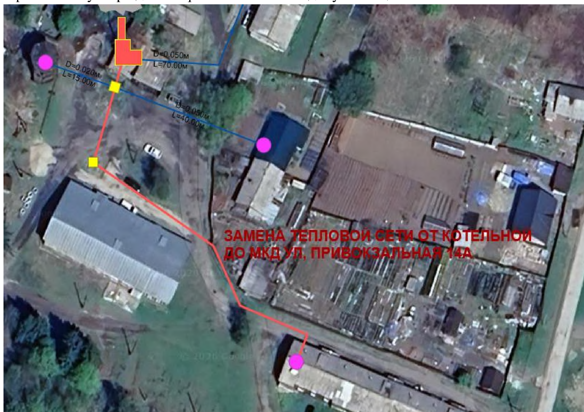
Рисунок 8.1. Замена тепловой сети от котельной до МКД ул. Привокзальная д.14а
