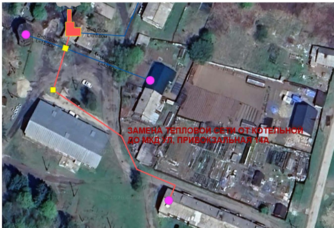
Рисунок 8.1. Замена тепловой сети от котельной до МКД ул. Привокзальная д.14а
