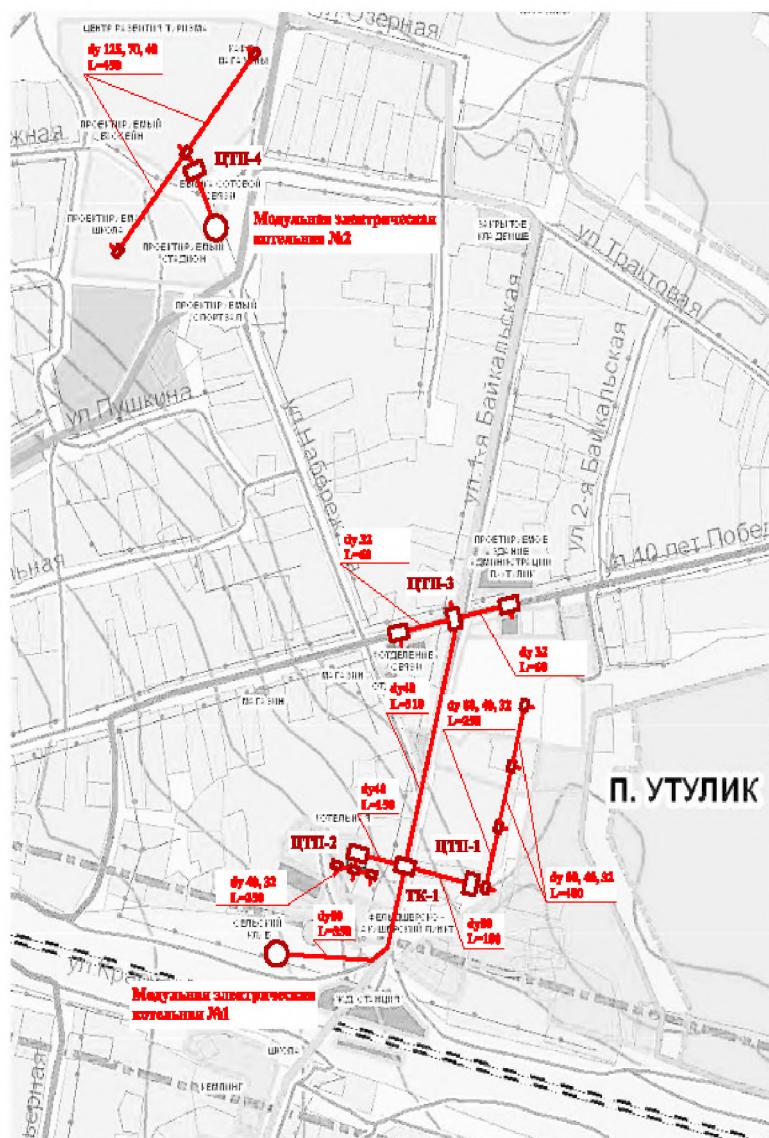
Рисунок 7.2. Схема теплоснабжения от модульных электростанций № 1, № 2
