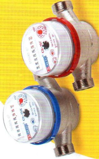
Счетчик воды (водосчетчик) — прибор учета, предназначенный для измерения объема воды, проходящего по водопроводу (расход воды). Чаще всего объем воды измеряют в кубических метрах — м<sup>3</sup>. Стандартные приборы учёта холодной воды работают при температуре до 40 °С, приборы учёта горячей воды — при температуре до 90 °С и давлении воды не более 1 МПа.
